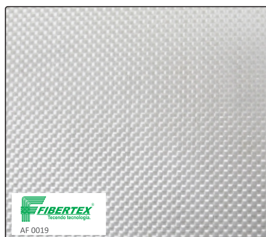
AF 0019 - Tela 1x1 Gramatura: 170g/m 2 Espessura: 0,16mm Largura: 1250mm
