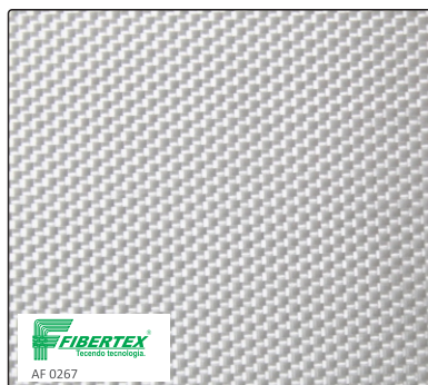
AF 0267 - Tela 1x2 Gramatura: 279g/m 2 Espessura: 0,24mm Largura: 1250mm
