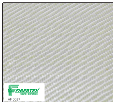
AF 0037 - Sarja 3x1 Gramatura: 270g/m 2 Espessura: 0,25mm Largura: 1300mm
