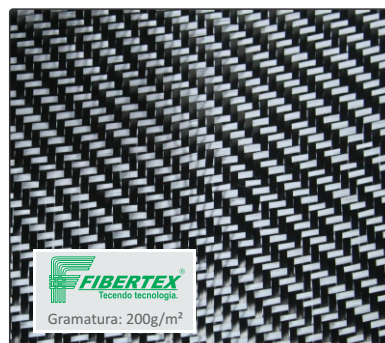
Artigo: AC - 0200 Desenho: Sarja 2x2 Espessura: 0,22 mm Largura: 1300 mm
