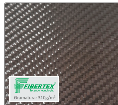
Artigo: CC - 0501 Desenho: Sarja 2x2 Espessura: 0,65 mm Largura: 1300 mm
