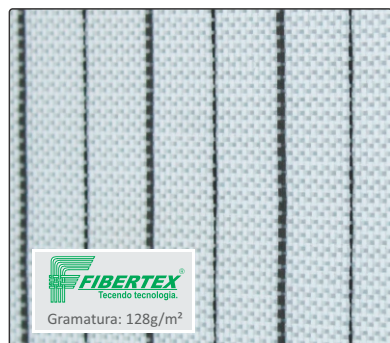
Artigo: AC - 0128 Desenho: Tela 1x1 Espessura: 0,25mm Largura: 1100mm
