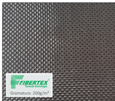
Artigo: CC - 0201 Desenho: Tela 1x1 Espessura: 0,35 mm Largura: 1270 mm
